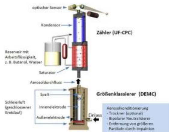
Abb. 2: Funktionsprinzip des Universal Scanning Mobility Particle Sizers (U-SMPS)
